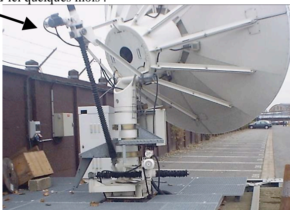
C'est une parabole pleine de 3,7M, à ce jour j'ai l'illumination de type CASSEGRAIN 73, Olivier F6HGQ
