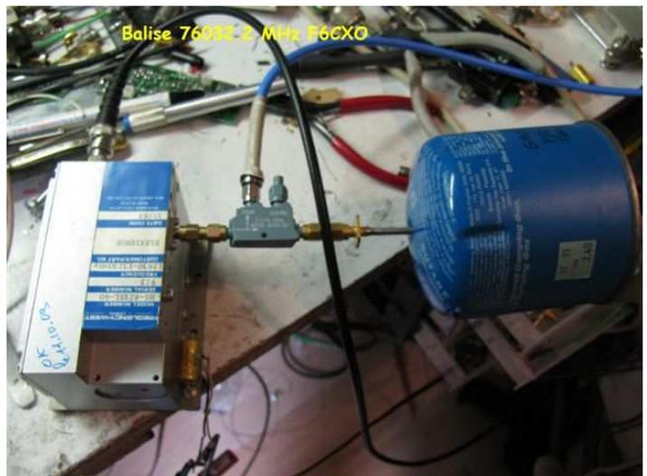
Balise 76 Ghz – Source Brick et fond de bouteille camping gaz en guise de parabole
