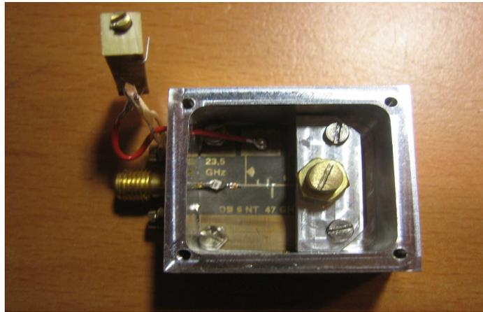
*PCB monté dans le boîtier*
