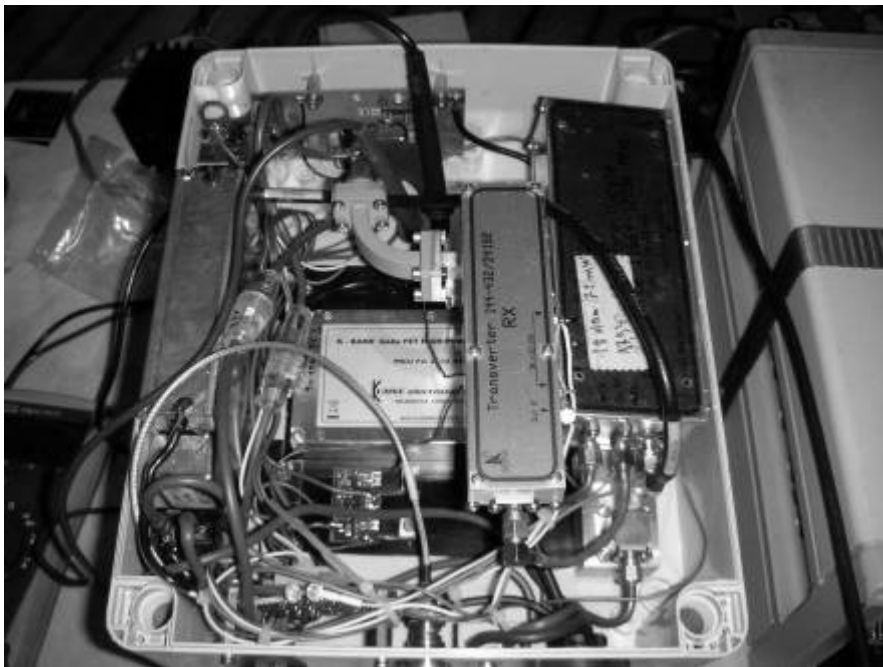
TVT 24 GHz F2CT à gauche le pilote 123 MHz F9HX, au centre le PA 11W DB6NT, à droite les modules I3OPW, I'OL et les tvt RX TX
