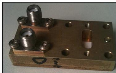
Je confirme que cela fonctionne en détecteur à 24GHz aussi, je me suis intéressé à l'adaptation en 24GHz ; mes moyens de mesure n'allant pas au dessus, rien n'a pu être fait en 47 et 76GHz. Des premières mesures m'ont interpellé car j'y voyais une adaptation quasi inexistante. Afin de confirmer mes mesures et améliorer leur précision, je suis allé voir Michel F1CLQ. A mes yeux, Michel est brillant dans ce genre de mesures et les visites chez lui sont toujours pour moi très instructives.
