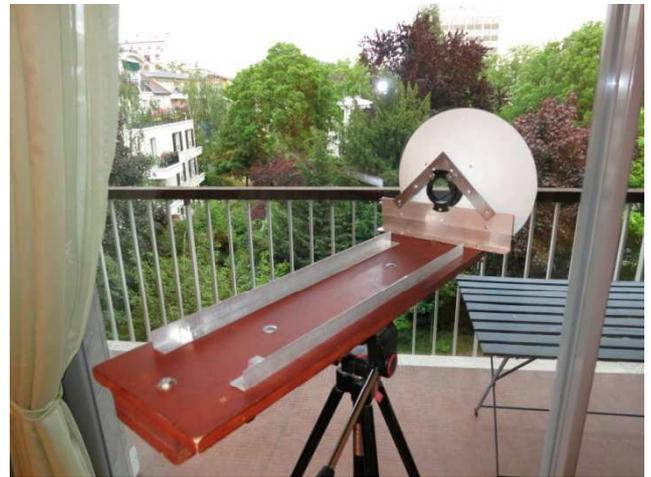
Il ne reste plus qu'à glisser le guide 47 GHz dans l'ouverture de la parabole afin de trouver le meilleur point focus
