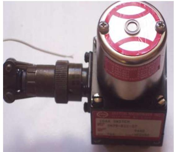
Ce relais est normalement alimenté avec le commun au PLUS, la tension nominale étant -20 volts, la bobine (moteur) a une course de 90°
