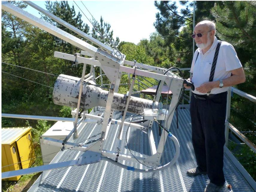
La station lunaire centrée autour d'un IC7800 Icom en FI 28 MHz précède un transverter 28/1296 MHz DB6NT. Un câble conduit les 18 watts au local PA 1296 MHz situé plus loin. Le coeur du pilotage de la station : un PC à 2 écrans gère le positionnement de la parabole en poursuite automatique de la Lune (1 degré toutes les 4 minutes environ) ou tout autre astre programmé, le Soleil par exemple.
