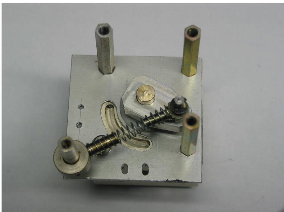
Ajuster le doigt de 3 mm dans la gorge (en arrondi) avec une lime fine pour obtenir un débattement de 90° (guide d'onde parfaitement en face des fenêtres).
