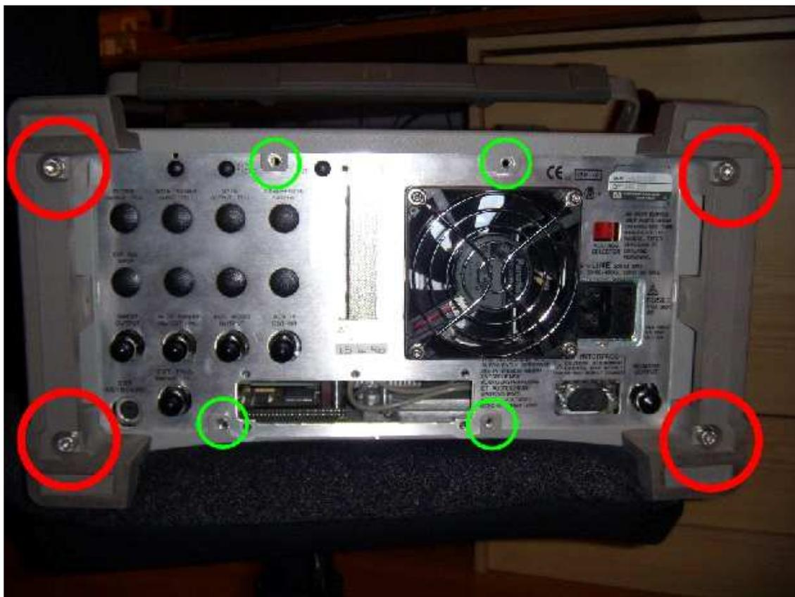
Illustration 2 : Pour démonter l'analyseur : Vis Imbus en rouge, vis Torx en vert.
