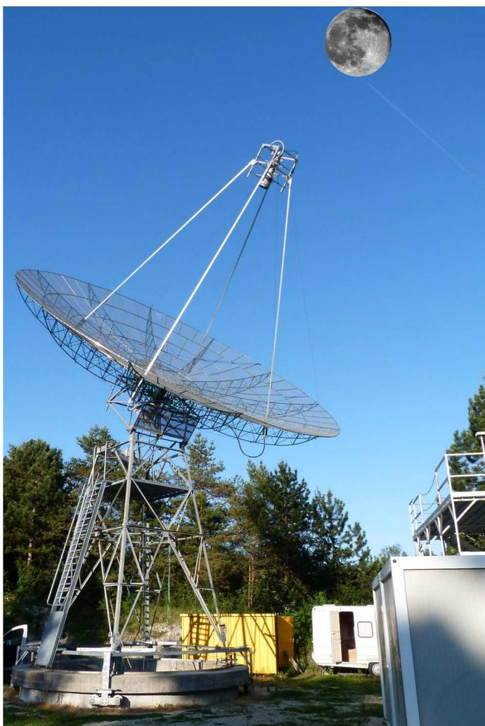
Le shack EME dont l'emplacement judicieux reçoit une plateforme d'où l'on peut intervenir en toute sécurité au niveau de la source de la parabole. Franck et son fils ont conçu à partir d'une console de jeux une télécommande sur 2,4 GHz : avec montée, descente, rotation, bref toutes manoeuvres et à la vitesse voulue.
