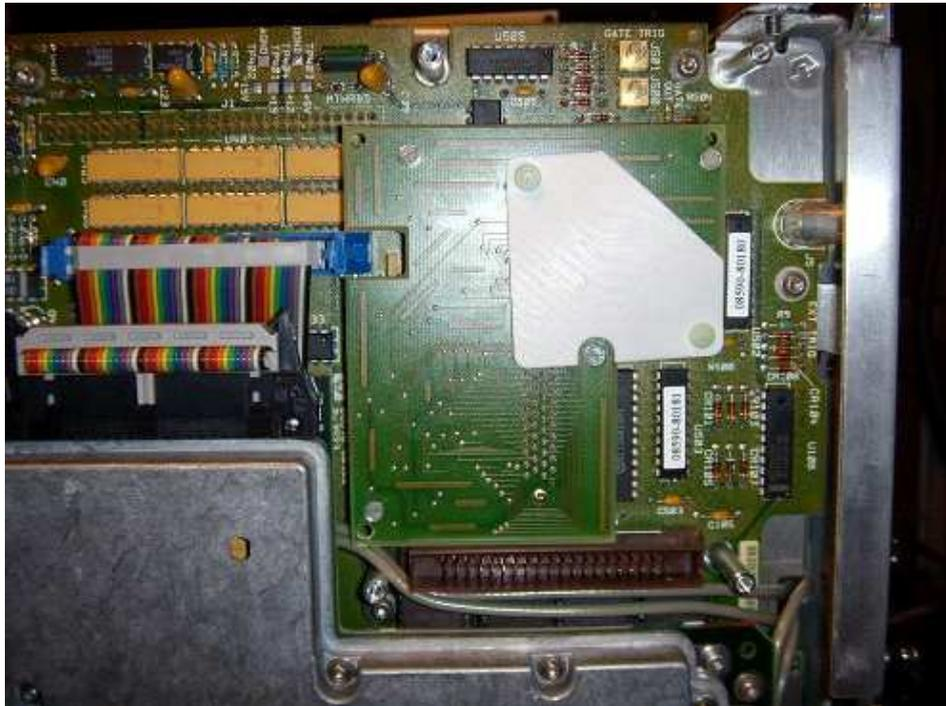
Illustration 7 : Le PCB supportant les RAM et la pile de back-up.
