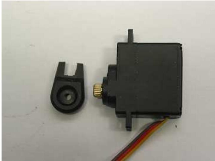
Servomoteur de type HD-1705MG (rapide) ou Hitec HS 81.
