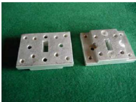
Une bride en WR42 pour montage en face avant de boîtier transverter. Et ci-dessus idem pour WR19/12/8/5
