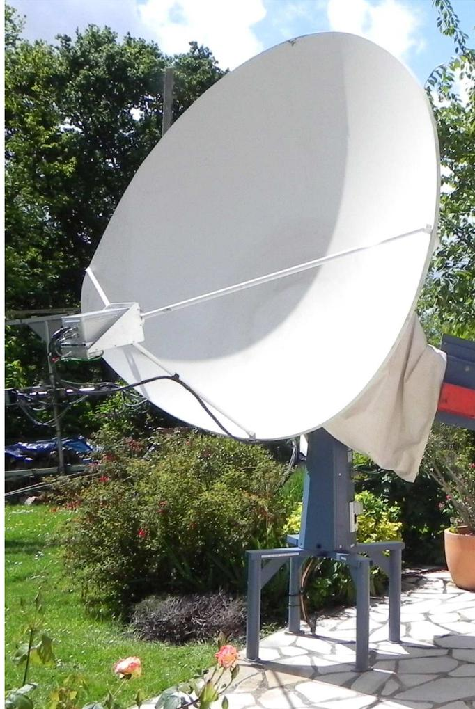
Mon problème était un peu différent et, n'ayant pas récupéré le radôme, j'ai dû changer les moteurs pas à pas pour des moteurs à courant, augmenter les démultiplications et renforcer les chaînes et pignons en site et azimut.
