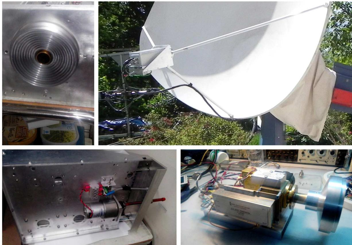
Faute d'avoir trouvé des transistors -15 j'ai mis des -12 qui me fournissent 25 watts en 10 GHz grâce au design simple et robuste des amplis conçus par F6BVA.
