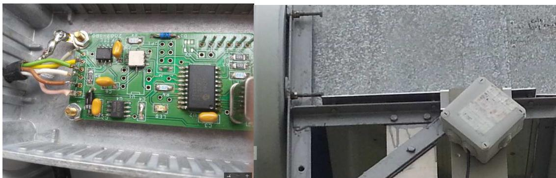
L'inclinomètre (à gauche) et sa boîte étanche.
