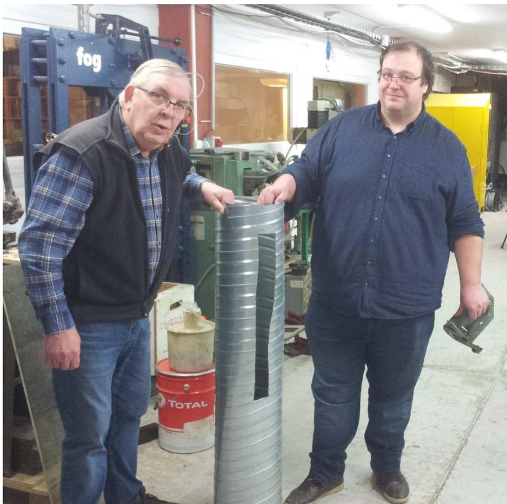
Vu les bons résultats obtenus avec les antennes à fentes sur les fréquences hautes, nous avons eu l'idée d'utiliser le programme de W1GHZ (slot antenna.xls) pour calculer les cotes de cette antenne fabriquée à partir d'une gaine de chauffage.
