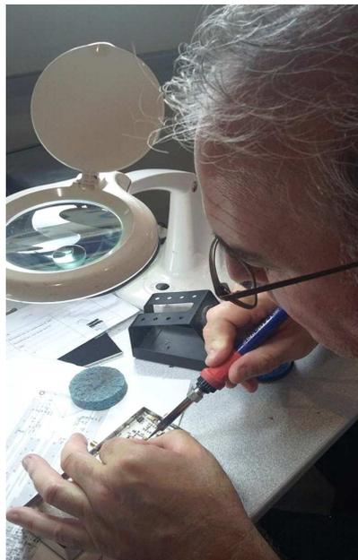
L'opération a quand même traîné sur une année faute d'avoir des temps libres en commun ! Il a fallu remplacer quelques transistors aux premiers essais mais rien de grave. Le séquenceur interne fonctionnant, nous avons mis en place l'OL. Les premiers tests sont concluants, le transverter sort ses mW.
