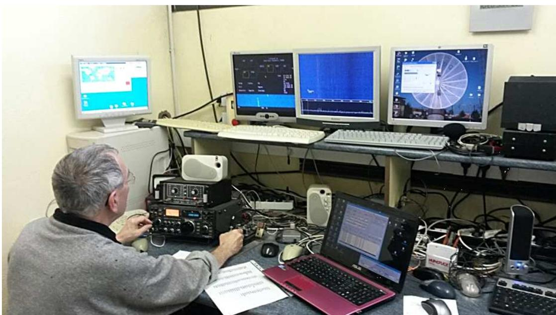
Sur la photo (crédit F8BMG) de gauche à droite : L'écran de poursuite F1EHN puis un écran filtre BF réglable qui permet de visualiser le correspondant et caler nos propres échos dans une bande de 1 kHz, puis l'écran SDR pour surveiller les 50 kHz de la bande CW, la parabole pour faire joli et le portable pour la saisie des QSO. La feuille sous plastique c'est la "Deep Search" !
