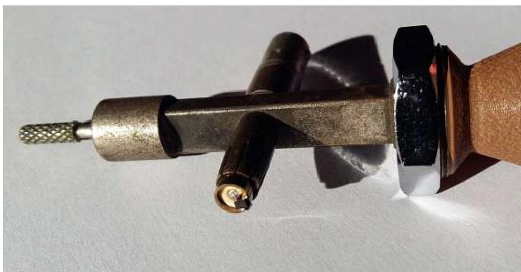
**Figure 2** – Zoom sur la diode HSMS-8101 soudée dans une ancienne 1N26 découpée. Un blindage cylindrique placé par-dessus permet d'éviter tout rayonnement direct par la diode.
